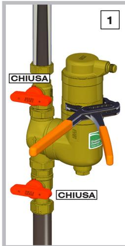
**1** Per effettuare la manutenzione, bisogna prima di tutto chiudere le valvole d'intercettazione poste prima e dopo il disaeratore (Fig.1). Successivamente svitare con l'aiuto di una chiave a pappagallo il corpo superiore ed estrarre la cartuccia per la pulizia (Fig.2).
